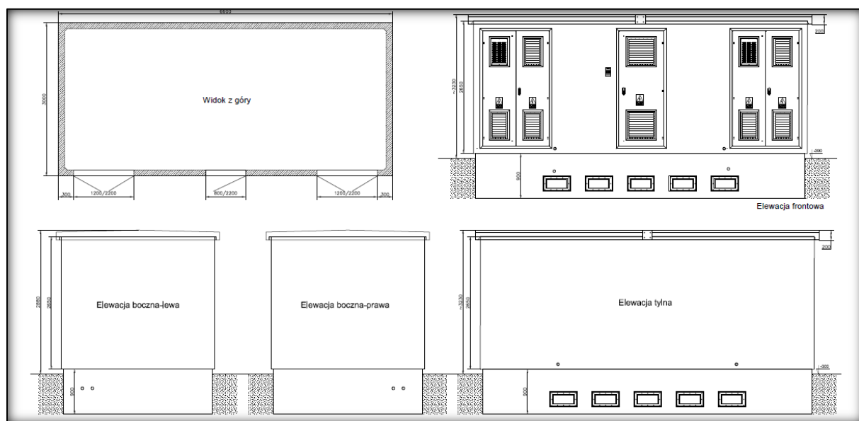
Rysunek 4 Schemat przykładowej stacji transformatorowej
